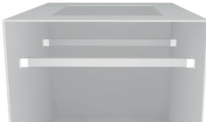
3) Platzieren Sie die Stützstangen in den Montagehalterungen.
