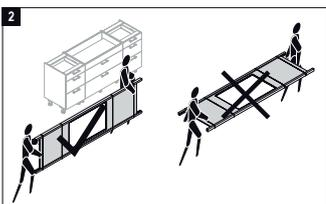
Die Platten, wegen Bruchgefahr, niemals unter Spannung montieren. Stellen Sie die Arbeitsplatte immer aufrecht auf die Unterschränke.
